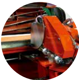
自動反転システム(特許申請中)は、自動2番取り研磨 によって作業者の張り付き作業を必要としません
