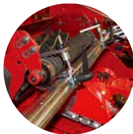
マルチ照準ポイント。簡単で速く、 シンプルにリールの芯出しが可能です
